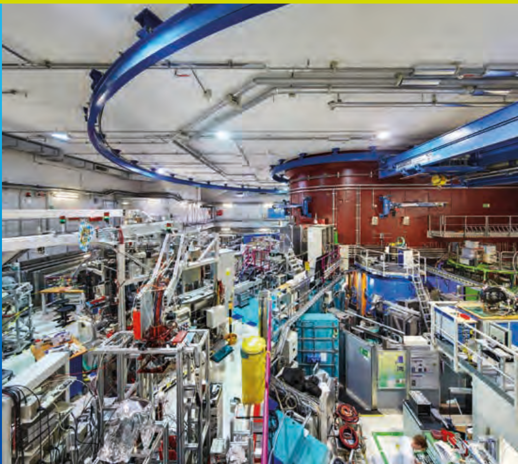
▲ Blick in die Experimentierhalle des FRM II in Garching. Die um den eigentlichen Forschungsreaktor angelegte Halle verfügt über rund 30 wissenschaftliche Instrumente, die über Strahlrohre mit Neutronen versorgt werden. Rund 1000 Wissenschaftlerinnen und Wissenschaftler im Jahr treiben hier ihre Forschung voran. (Bild: Bernhard Ludewig)
