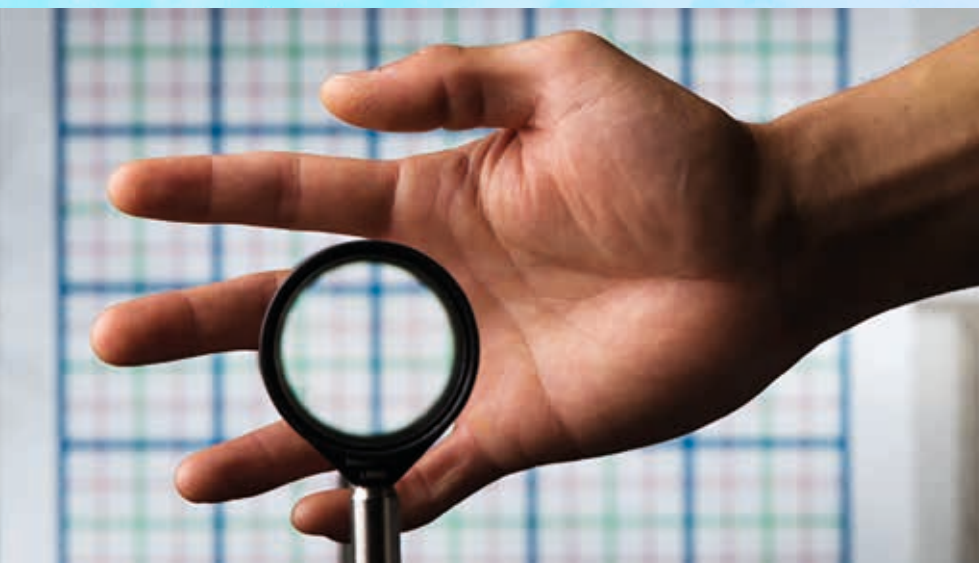
▲ Von Harry Potter inspiriert, entwickelten Forscher der Universität von Rochester eine neue Art von Tarnumhang. Sie setzten nicht auf teure digitale Metamaterialien, sondern einfach auf vier Linsen, von denen jeweils zwei die gleiche Brennweite haben. Entscheidend ist ihre Anordnung: Das Licht wird von der ersten Linse auf einen Punkt fokussiert, dann von der zweiten mit der anderen Brennweite. Der Vorgang wird vom zweiten Linsenpaar wiederholt. Dadurch wird das Licht so umgelenkt, dass ein Gegenstand für den Betrachter, der durch den Linsenaufbau schaut, unsichtbar erscheint. (Bild: J. Adam Fenster/University of Rochester)
