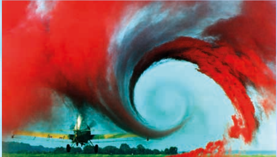
▲ Die Beschreibung des turbulenten Verhaltens von Flüssigkeiten und Gasen erfordert enorme Rechenleistungen – sei es beim Schütten von Milch in eine Kaffeetasse oder bei der Berechnung von Wirbelschleppen beim Start eines Flugzeugs. (Bilder: StockSnap, CCO | NASA/Langley Research Center, CCO)
