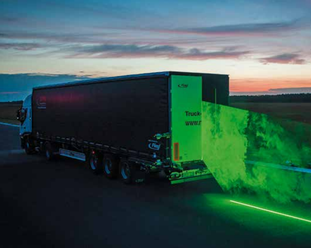
▲ Mit Laser und Rauch machen Forscher des Deutschen Zentrums für Luft- und Raumfahrt die Strömungen hinter einem 40-Tonnen-Sattelzug sichtbar. Ihr Ziel: LKW aerodynamisch besser und somit spritsparender zu machen. (Bild: DLR)
