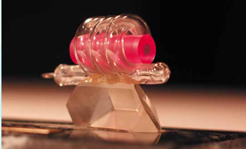
▲ Der erste Laser, 1960 von Theodore Maiman gebaut. Als Lasermedium diente ein Rubin. Die Blitzlampenspirale „pumpte“ ihn. So ein Rubinlaser konnte nur kurze Laserpulse produzieren. (Bild: Roland Wengenmayr)
