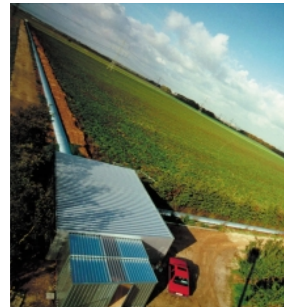
► Zwei Laserstrahlen laufen in diesen langen Röhren senkrecht aufeinander zu. In der Hütte werden beide miteinander verglichen. Läuft eine Gravitationswelle durch das Gebiet, verändert sie die Strahlen unterschiedlich – und das kann gemessen werden. (Foto: P. Aufmuth, Uni Hannover)
