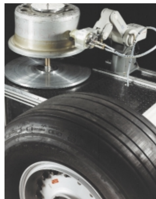
◀ Ein SQUID prüft den Zustand einer Flugzeugfelge. Kleinste Risse verraten sich hier durch Mini-Magnetfelder, die an solchen Stellen im Material entstehen. (Foto: Forschungszentrum Jülich)
