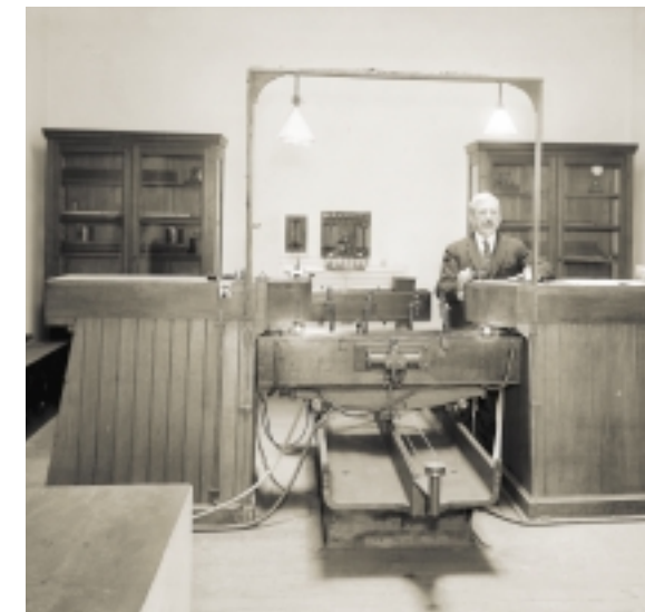
▲ Charles Edouard Guillaume beim Vermessen einer Kopie des „Ur-Meters“. Solche Eichstandards aus Invar-Stahl veränderten ihre Länge bei Temperaturänderungen kaum. (Foto: Transglobe Agency/Roger-Viollet)
