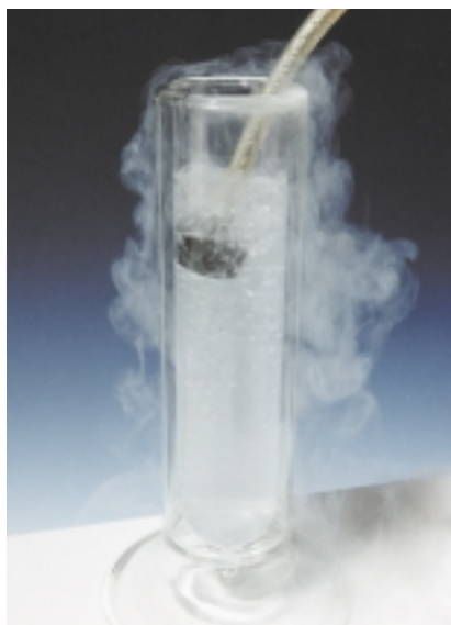
▲ „Hochtemperatur“-Supraleiter verlieren bereits bei der Temperatur von flüssigem Stickstoff (-196°C) ihren elektrischen Widerstand. (Foto: Forschungszentrum Jülich)
