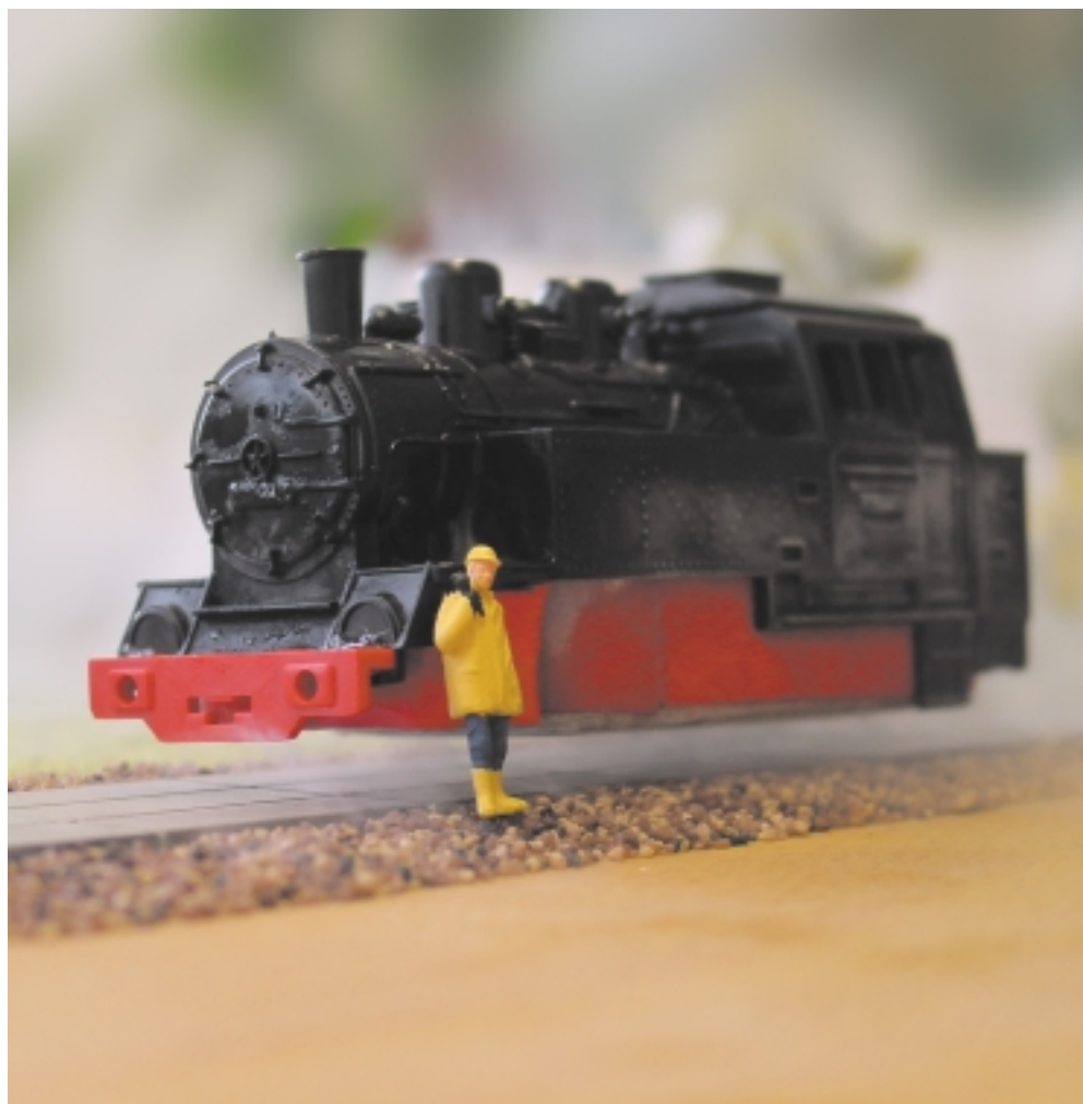
▲ Supraleitende Schwebbahn. Die Lok wird auf einer bestimmten Höhe gehalten und der darin befindliche Supraleiter mit flüssigem Stickstoff heruntergekühlt. Er „krallt“ sich dann am Magnetfeld der magnetischen Schienen fest und die Lok schwebt. (Foto: E. F. Wassermann, Uni Duisburg)
