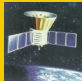
Der Satellit COBE (Cosmic Microwave Background Explorer), mit dem 1990 die Temperatur der Mikrowellenstrahlung auf ein tausendstel Grad genau gemessen wurde.
