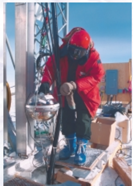
Am Südpol entsteht das riesige Neutrinooteleskop AMANDA, bei dem die Lichtblitze von Neutrinoreaktionen mit Lichtsensoren nachgewiesen werden, die kilometertief im Eis versenkt werden.
