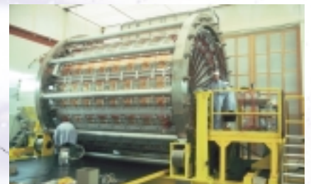
Der zentrale Spurdetektor zum Vermessen der Flugbahnen der Teilchen.
