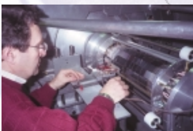
Der Silizium-Halbleiterdetektor zur präzisen Vermessung der Spuren nah am Kollisionspunkt.
