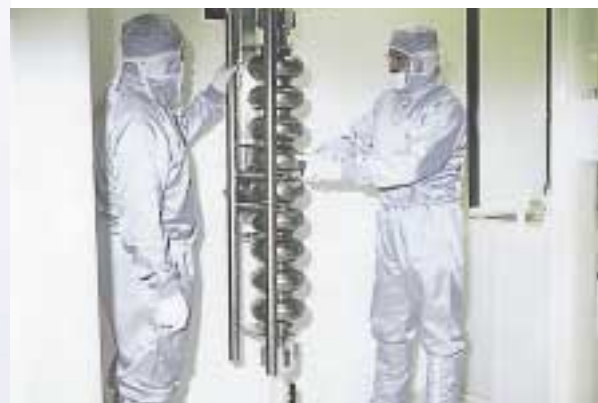
Test der supraleitenden Beschleunigerstruktur im Reinraum. (Foto: DESY)
