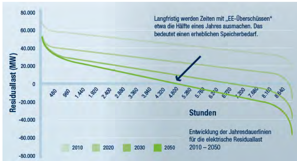
Abb. 1: Der Speicherbedarf wird mit dem geplanten Ausbau der regenerativen Stromerzeugung wachsen: Entwicklung Jahresdauerlinie für die elektrische Residuallast in Deutschland (Bildquelle: DVGW e.V., Daten aus [10])
