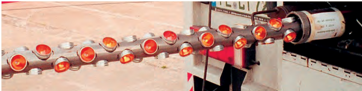
Abb.3 (a): Eine Perforationssonde vor dem Einsatz
