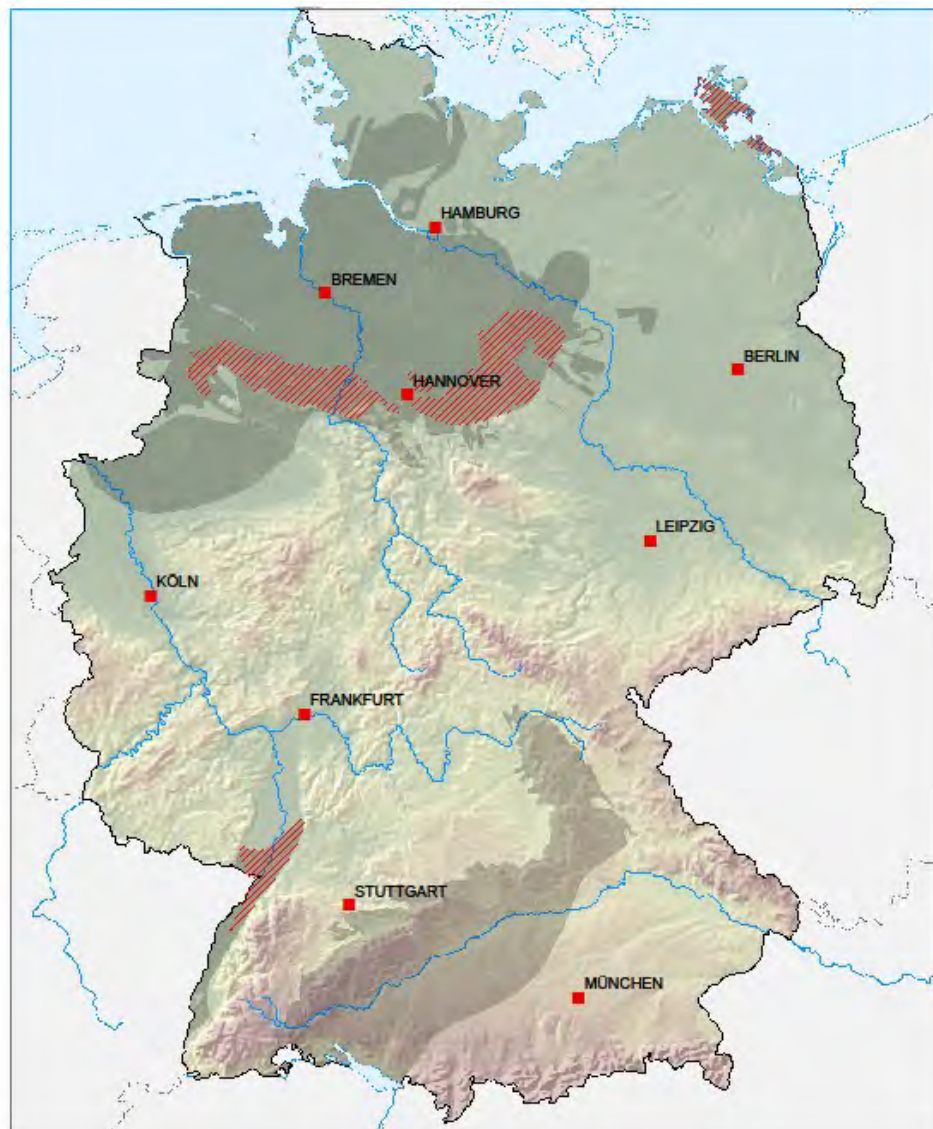
Abb. 3: Verbreitung von bituminösen Tongesteinen, die grundsätzlich die Voraussetzung für die Bildung von Schiefergas aufweisen können (graue Fläche). Die Flächen zeichnen im Wesentlichen die bekannten Kohlenwasserstoff-Provinzen in den großen Sedimentbecken nach. Rot-schraffierte Flächen entsprechen den Regionen, die nach Anwendung weiterer Screening-Kriterien für die Potenzialabschätzung herangezogen wurden. (Quelle BGR)
