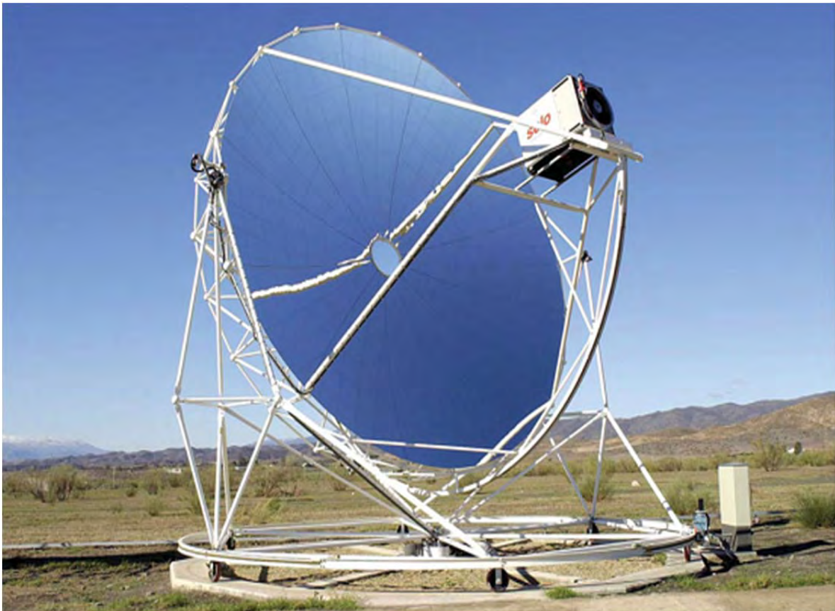
Abbildung 5: Beispiel eines Dish-Stirling-Systems
