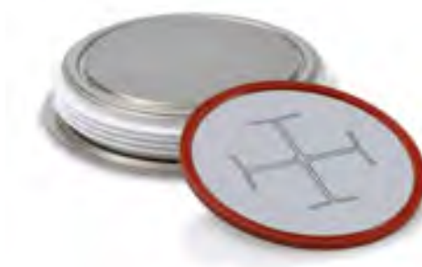
Abb. 2: 6-Zoll-Leistungsthyristor [Quelle: ABB]. Sperrspannung: 8,5 kV. Stromtragfähigkeit: 4,5 kA.
