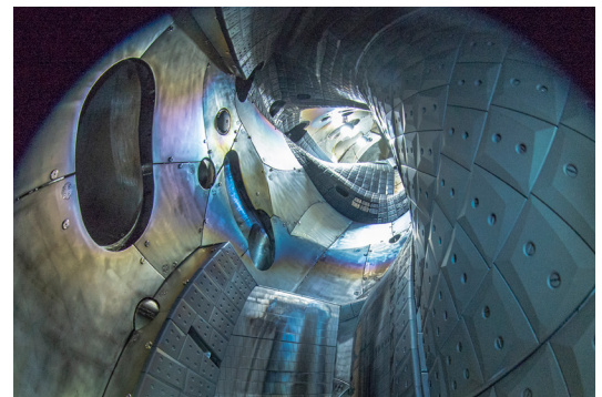
Blick in das Plasmagefäß von Wendelstein 7-X, das der helikalen Plasmaform folgt. Zu sehen sind Zugänge zum Plasmagefäß und Wandauskleidungen aus Kohlenstoff und Stahl. © IPP, Foto: Christoph Biedermann, Glen Wurden
