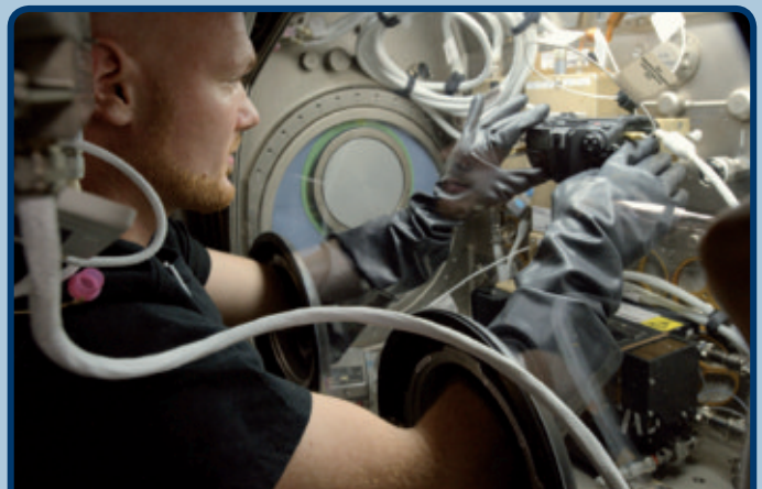
So sieht der Handschuh-Kasten auf der Raumstation aus. Darin werden zum Beispiel Versuche durchgeführt, bei denen es um Stoffe geht, die man nicht berühren oder einatmen sollte. Bild: NASA/ESA
