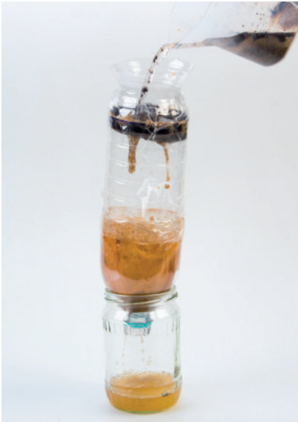
Die selbst gebaute Wasseraufbereitungsanlage. Bild: DLR/Timm Bourry
