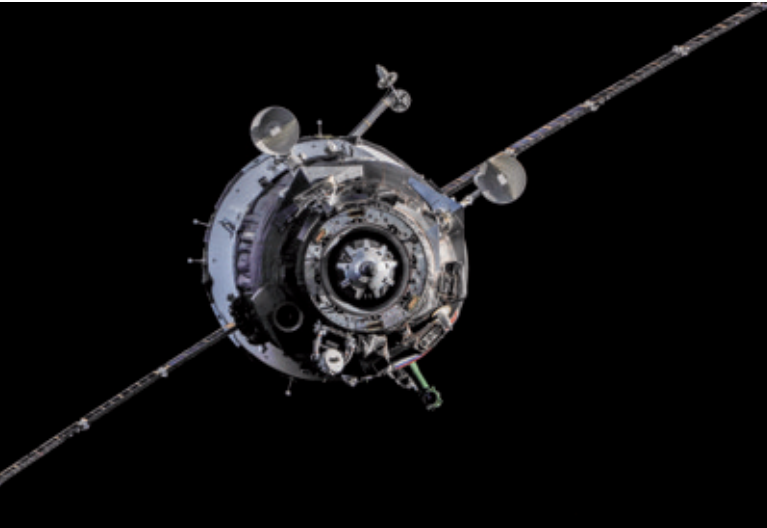
Ein Sojus -Raumschiff im Anflug auf die ISS . Unten rechts auf der 5-Uhr-Position ragt (gut an der grünen Farbe erkennbar) das Periskop hervor. Das Bild des Periskops wird der Crew auf einen Monitor übertragen. Oben auf 11 und 2 Uhr befinden sich die Antennen des automatischen Dockingsystems. Vorne an der Spitze ist der Andock-Mechanismus zu sehen. Bild: NASA
