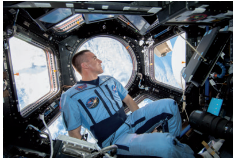
Ein Crewmitglied in der Cupola. Von hier aus können die Astronauten den außen an der Station angebrachten Robotikarm sehen und steuern – etwa, um unbemannte Frachtschiffe einzufangen. Aber natürlich nutzen sie die „Aussichtskuppel“ auch für den Blick auf unseren Planeten. Bild: NASA
