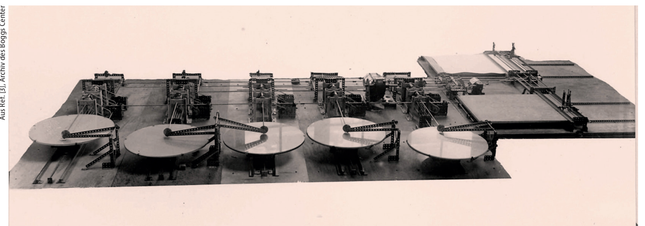
Abb. 1 Differentialanalysator nach dem Cambridge-Meccano-Modell mit den fünf integrierten Einheiten – einschließlich der von Monroe. Der Zeichentisch befindet sich oben rechts. Heute ist das Gerät im Museum of Transport and Technology im neuseeländischen Auckland ausgestellt.
