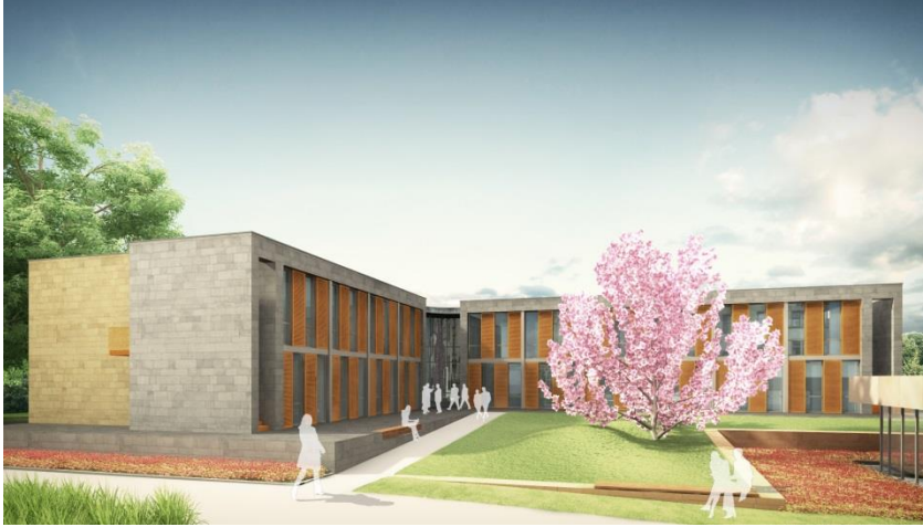
Das Gästehaus wird in seiner äußeren Erscheinung als Neubau erkennbar gestaltet, sich aber dennoch in Materialwahl, Farbgebung und Proportion an das Stiftsgebäude anpassen. (künstlerische Darstellung; Luft-Brix Architekten)
