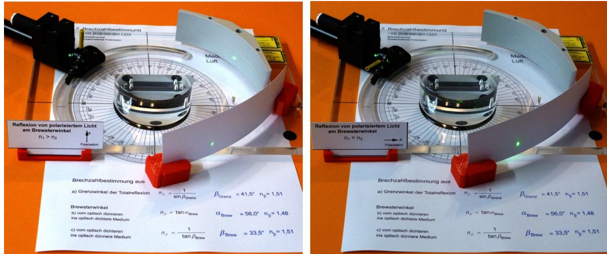
Reflexion von polarisiertem Licht am Brewsterwinkel
