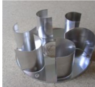
Abb. 6 Turbinenrad vor dem Aufkleben der oberen CD
