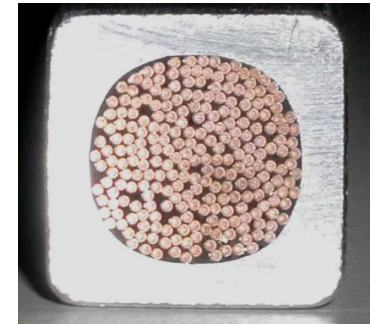
Cable-in conduit conductor NbTi
