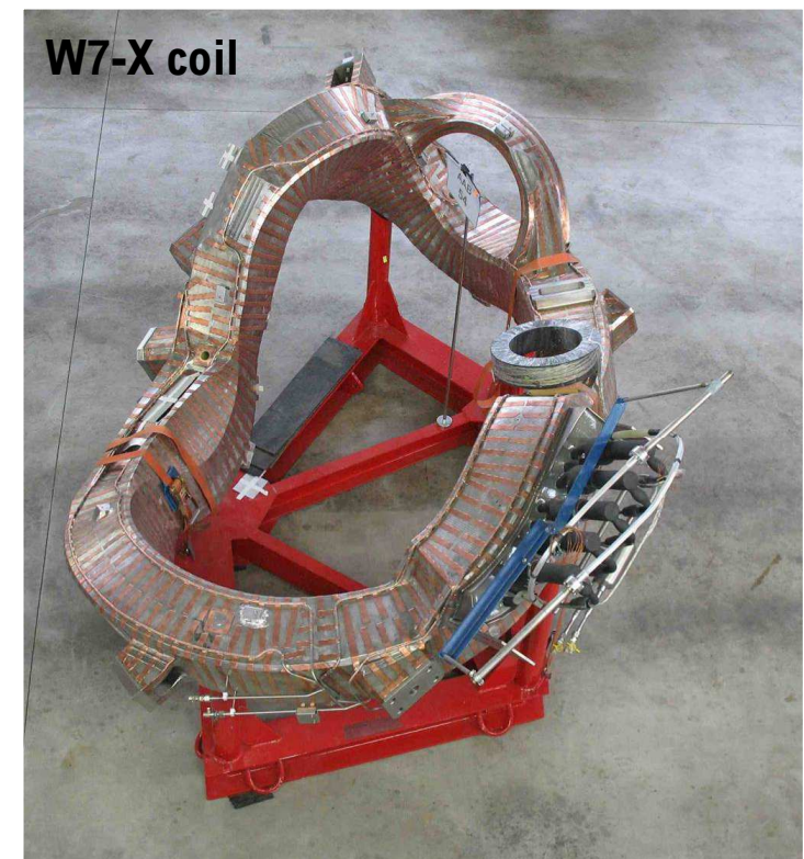
Cable-in conduit conductor NbTi
