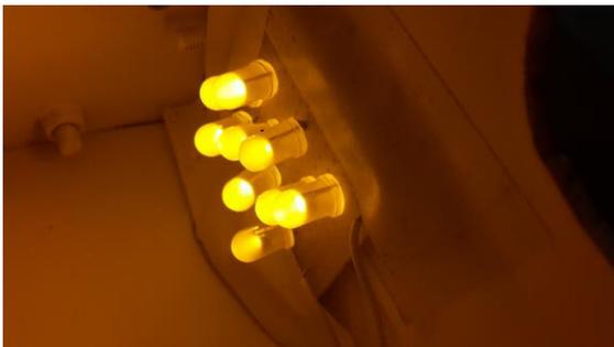
**Unteres gelbes Fach** wird beleuchtet mit gelben LEDs. Dieselbe Paprikaschote kann kein rotes Licht reflektieren und sieht alt aus.
