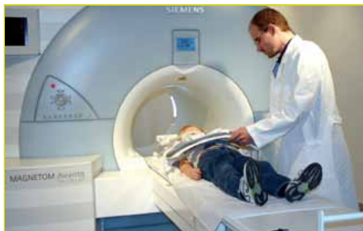
Herzstück eines MRT-Gerätes ist ein röhrenförmiges Bauteil. Dieses beherbergt die elektrischen Spulen, mit denen die elektromagnetischen Felder erzeugt werden.
